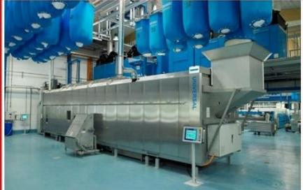
Abb: Eine Taktwaschanlage (Waschstraße) mit automatischer Sackbeladung
